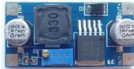
XL6009 STEP UP MODULE I/P:- 5V- 32V O/P:- 4V- 38V / 4A
