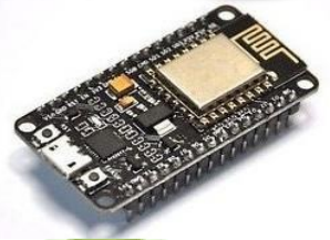
NODMCU Esp8266- 12 USB CH340
