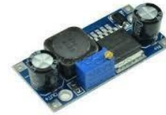
LM2596 STEP DOWN MODULE I/P:- 4.5V to 35V O/P:- 1.3V- 30V / 3A
